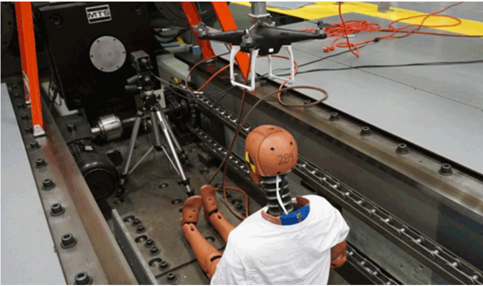
Рисунок 2. Моделювання результатів зіткнення БПЛА з головою людини 1 .
